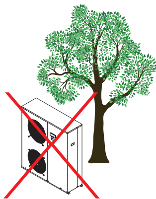
Figura 6.8: installazione non corretta dell'unità esterna.
